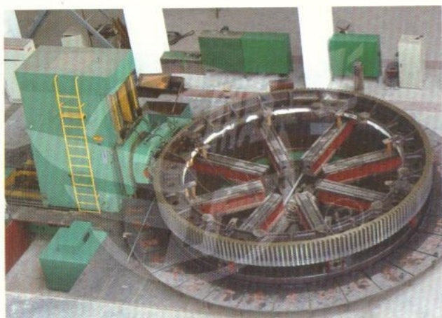
\phi 12.0 米滚齿机 (俄罗斯产) \phi 12.0m Hobbing Machine (Made in Russia)
